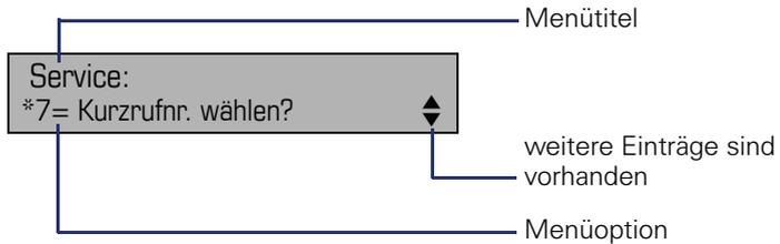
Der Doppelpfeil neben einem Eintrag bedeutet dass der entsprechende Eintrag weitere Optionen enthält. Die Menüstruktur umfasst mehrere Ebenen. Innerhalb dieser Struktur zeigt die erste Zeile das gerade gewählte Menü und die zweite Zeile eine Option dieses Menüs.
