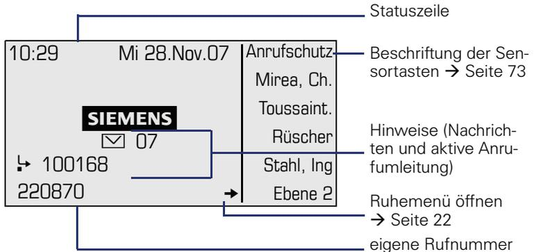
Der linke Bereich enthält in der 1. Zeile die Statuszeile und darunter einen 5-zeiligen Bereich für weitere Anzeigen.
