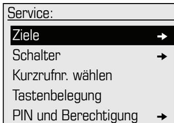
Die Menüstruktur umfasst mehrere Ebenen. Innerhalb dieser Struktur zeigt die erste Zeile das gerade gewählte Menü und die zweite Zeile eine Option dieses Menüs. Der Pfeil neben einem Eintrag bedeutet dass der entsprechende Eintrag weitere Optionen enthält.
