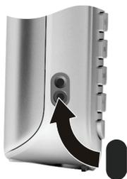
Mitgelieferte Kunststoffabdeckung für die Headsetbuchse einsetzen, um einen optimalen Klang im Freisprechmodus zu ermöglichen.
