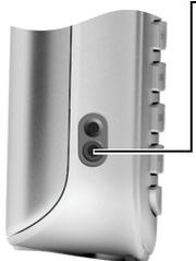
Nach Entfernen der Kunststoffabdeckung können Sie ein Headset mit 2,5 mm Klinenstecker an der linken Seite Ihres Mobilteils anschließen.
